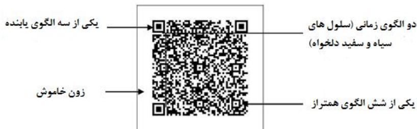
شکل ۴: نمونه‌ای از یک QRCode و ساختار آن [۲۲].
